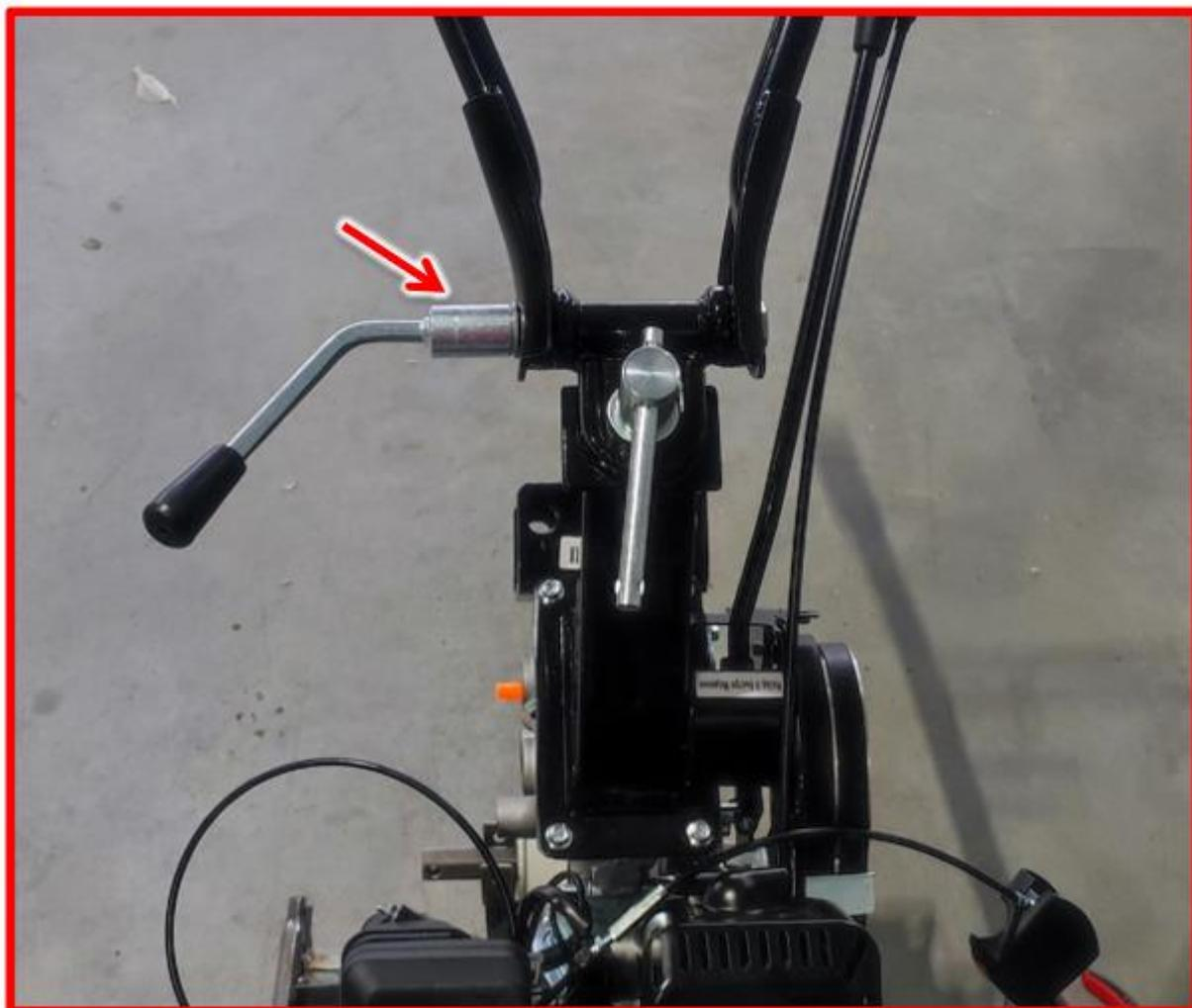
На правой ручке руля установить и закрепить рычаг газа крепежом (болт М6х50, гайка самоконтрящаяся М6).
