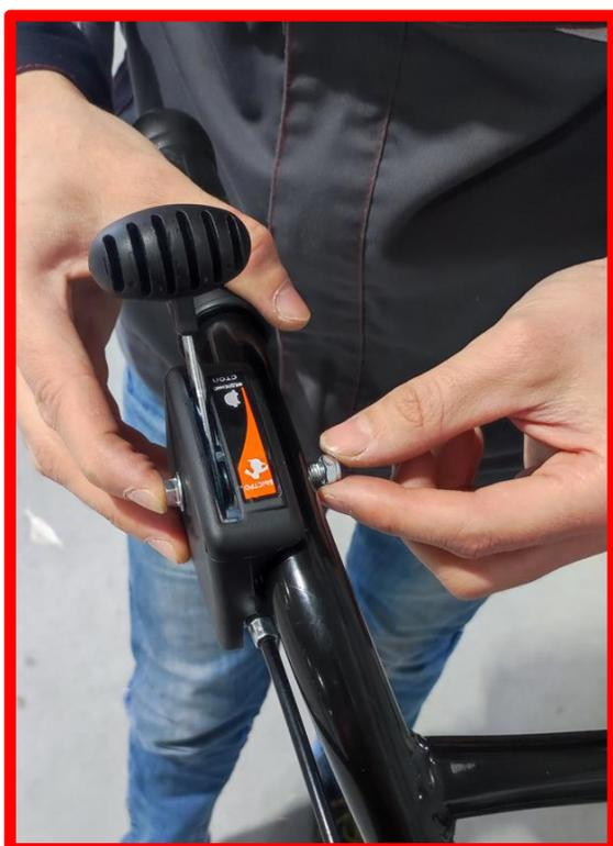
Зафиксировать трос газа и сцепления фиксаторами.
