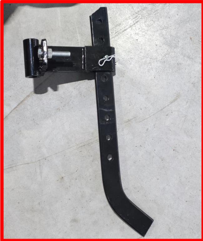
Установить и зафиксировать кронштейн крепления сошника с помощью 3х штифтов  $\varnothing 16 \times 120$  со шплинтами.
