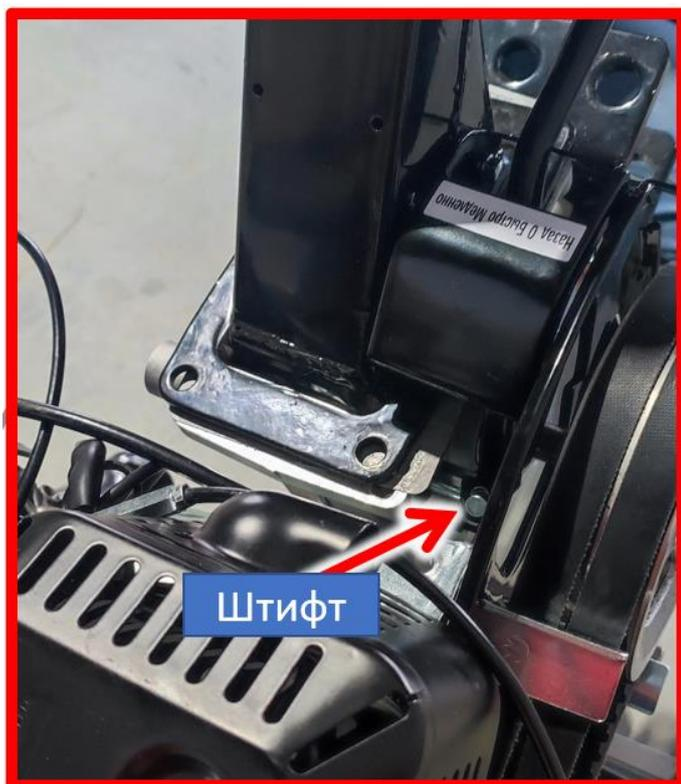
Зафиксировать рулевую колонку на редукторе с помощью болтов М8х20 (обязательно контролировать положение паронитовой прокладки).
