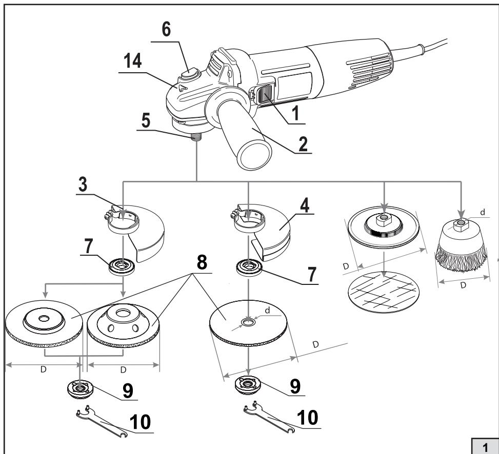
**D** - Максимальный Ø диаметр рабочего инструмента;
