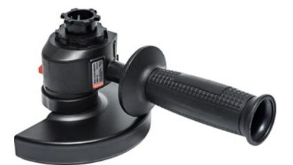
УШМ используется коническая передача). Кожух крепится на винтовом хомуте, для смены оснастки используют кнопку блокировки шпинделя и специальный входящий в комплект ключ. Передняя рукоятка имеет возможность установки в двух положениях.
