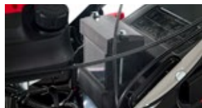
Электрозапуск от аккумулятора
